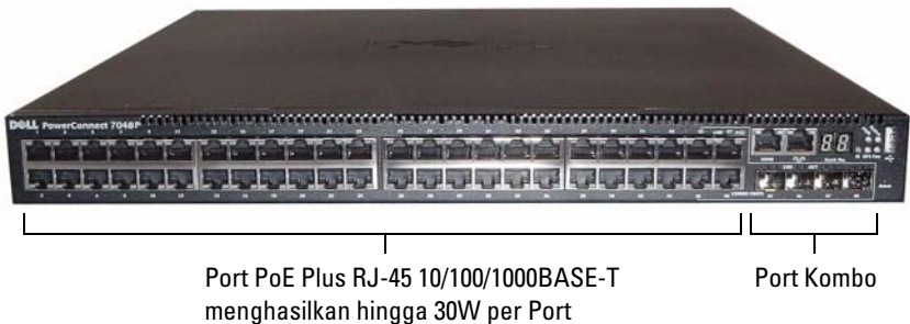
Gambar 1-5. PowerConnect 7048P dengan 48 Port PoE Plus 10/100/1000BASE-T
