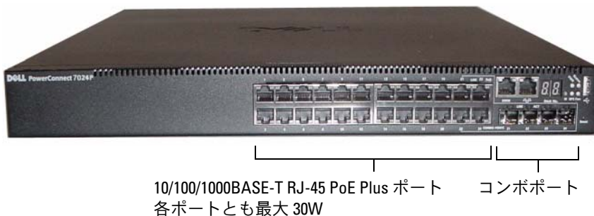
図 1-2. 10/100/1000BASE-T PoE Plus ポートを 24 個備えた PowerConnect 7024P
